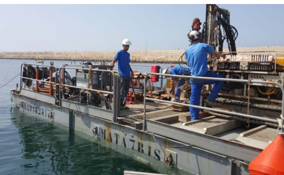
→ Investigations maritimes | Sondages carottés et essais mécaniques
