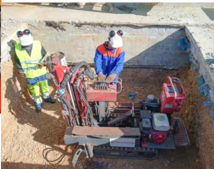
→ Essais in situ | Essais au pénétromètre dynamique
