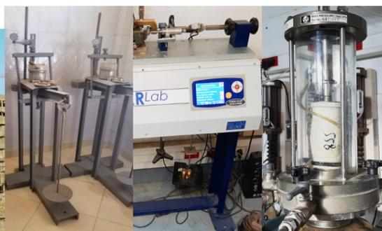
→ Essais d'identification GTR, de compactage et de mécanique des sols
